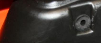
Den Gummidübel bis zum Anschlag durch die Bohrung schieben
