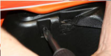
Mit einem 8mm Bohrer vorbohren und dann mit einem 17mm Bohrer nachbohren. Sollten Sie keinen passenden Bohrer zur Hand haben, wenden Sie sich bitte an Ihren Fachhändler.
